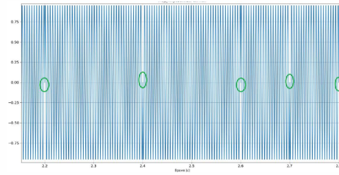
Пример реализации сигнала 2ФМ (зеленым овалом отмечены изменения фазы)
